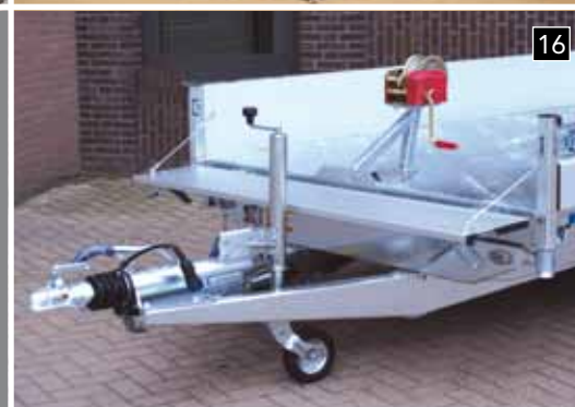
Foto 16: ► Afneembare lier steun met lier in combinatie met scharnierend voorbord
