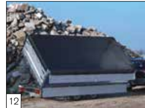
Optie: pendel-opzetborden met fijnmazig ladingnet (gemonteerd).
