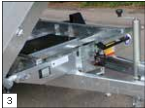
Optie: voorzien van noodhandpomp bij elektrische pomp.
