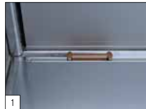
Standaard: voorzien van TÜV-gecertificeerde bindbeugels met een capaciteit van 1000 daN.
