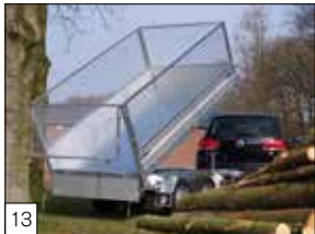
Optie: afneembaar gaasrekwerk 700 mm hoog en gaasrekken vanaf 3350 mm, versterkt met zijstaanders.
